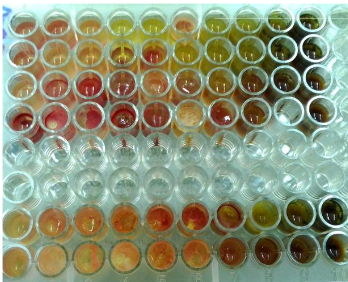
شکل شماره ۱: تعیین حداقل غلظت مهارکنندگی از رشد اسانس ترخون، با استفاده از پلیت ۹۶ خانه‌ای و معرف تری فنیل تترازولیوم.
