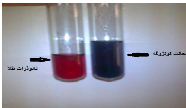
شکل شماره ۳: محلول‌های نانوذرات طلا و کونزوگه آن با فلوکونازول، پس از سنتز به طریق احیای شیمیایی
